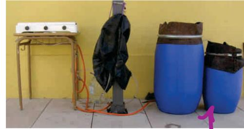
Un biodigestor es un contenedor cerrado, hermético e impermeable (llamado reactor) donde se depositan materiales orgánicos para fermentar (desechos humanos, animales y plantas). Dejándolo reposar producirá gas metano.
